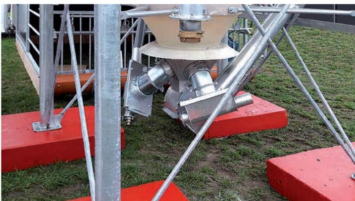
OPTIONAL: 3-seitiger Anschlussstrichter aus Edelstahl, für Entnahme mit Schnecke und Förderspirale an einem Silo.
