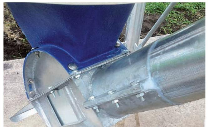
Schneckenkasten 20–60° verstellbar, für restlose Entleerung
